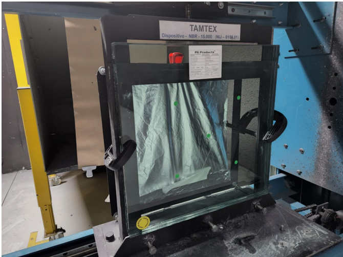
Imagem 11 - corpo de prova de vidro balístico de 40 mm com os pontos de tiro conforme NBR 15000-2
