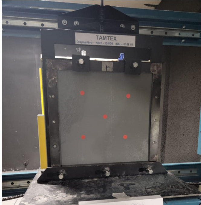
Imagem 06 - corpo de prova de aço balístico de 6 mm com os pontos de tiro conforme NBR 15000-2
