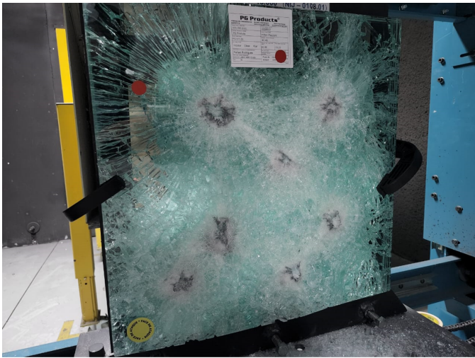
Imagem 12 - corpo de prova após 7 disparos
