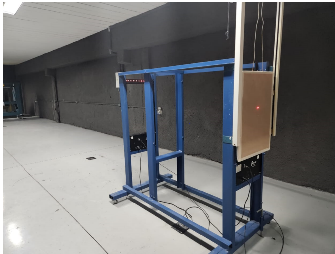
Imagem 02 - Cronógrafo de velocidade
